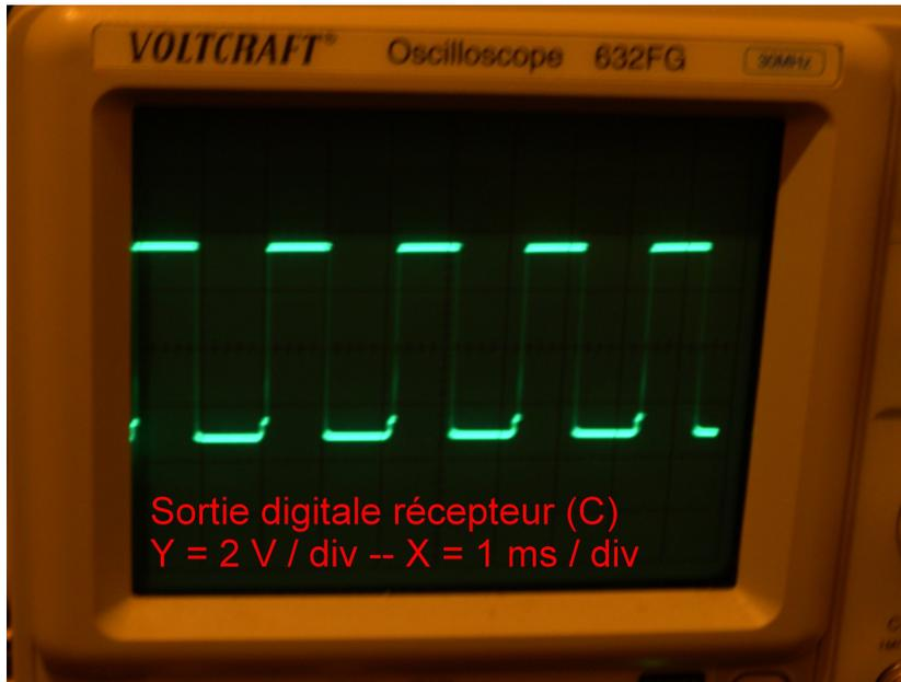
*Illustration 6: Sortie numérique, après mise en forme par le trigger de Shmidt.*
